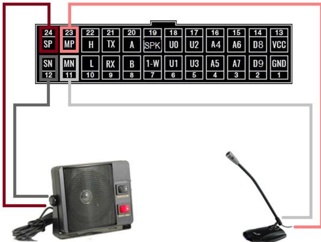
Рисунок 9 – Схема подключения микрофона и динамика
