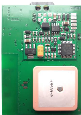
Рисунок 3. ARNAVI INTEGRAL 2 с установленным модулем управления
